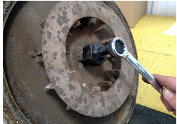
AHS Fan Puller Tool at the Ready
