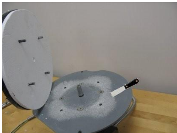
Séparer l'écran thermique de la plaque de montage du moteur
