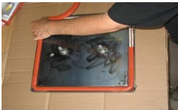
Ajout d'un cordon de silicone préformé à la porte
