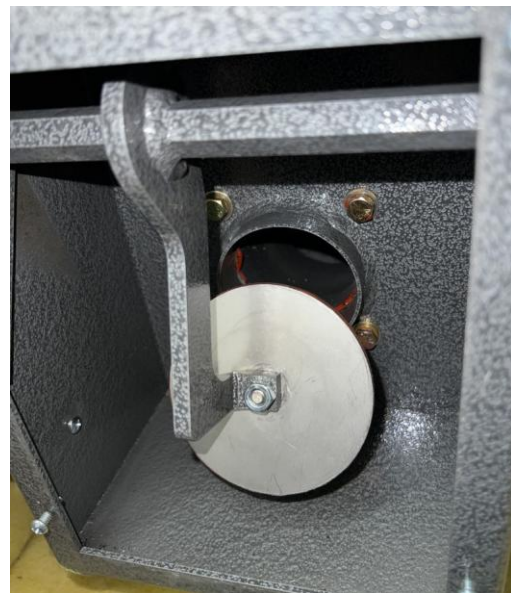
S Disque de la vanne d'air ECONDARY en position ouverte
