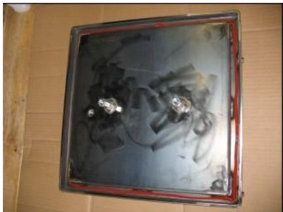
Porte de chargement avec l'ancien joint enlevé et le silicone haute température
