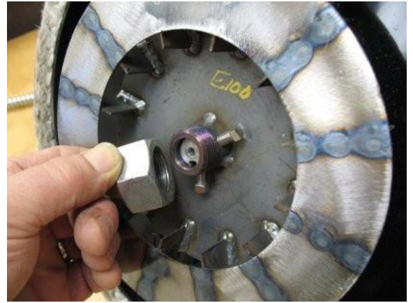
Écrou d'un pouce pour tirer le ventilateur
