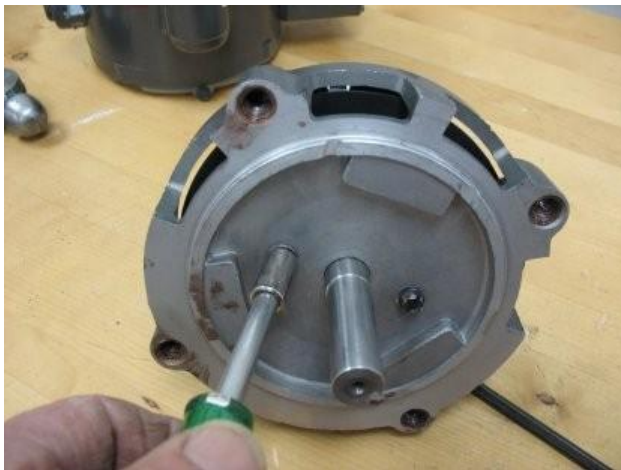
Desserrer les vis qui fixent le palier à l'écran d'extrémité
