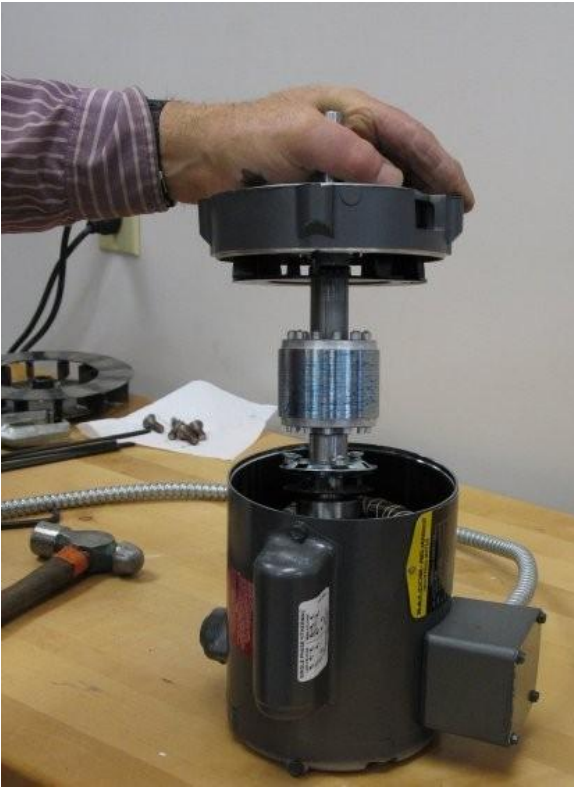
Soulever le bouclier d'extrémité avec l'armature
