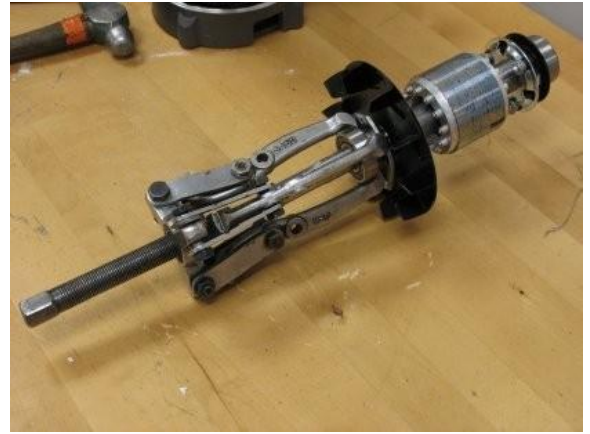
L'extracteur de mâchoires est prêt à intervenir sur le palier du moteur
